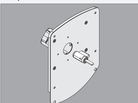
4. De l'EXTÉRIEUR, tournez la came de la clé **dans le sens contraire** des aiguilles d'une montre jusqu'à ce qu'elle s'arrête.
