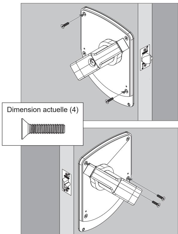
7b Vérifiez le fonctionnement. Si le fonctionnement ne se fait pas sans heurt, desserrez les vis puis soulevez la garniture de la porte jusqu'à ce que le mouvement se fasse sans heurt. Installez ensuite les vis pour le montage en surface.
