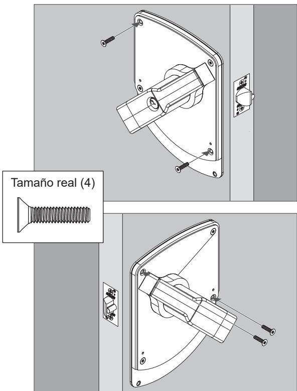
7b Compruebe si funciona. Si no funciona de manera suave, afloje los tornillos y levante la moldura sobre la puerta hasta que lo haga correctamente. Luego instale tornillos de montaje en superficie.
