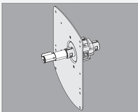
6. Vuelva a instalar el chasis y la subplaca en la moldura.
