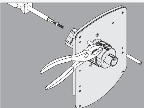
2. Séparez le châssis et la plaque auxiliaire de la garniture.
